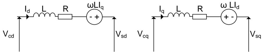
**Figure 13: Equivalent dq circuit diagrams**
