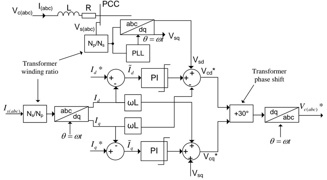
Figure 19: dq current controller implementation
